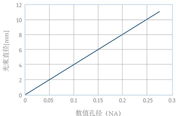
基本直径的设置如左图所示。针对355、532、632、780和1064[nm]波长进行预对准，a|AspheriColl可准直NA最高达0.275的单模光纤的输出。
