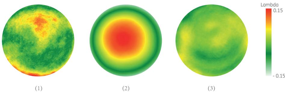
a|Wave  $\lambda$  dapt的优化设计旨在补偿当获取准直光束时导致在实际情况下出现的衍射受限波前的合理像差量。因此，a|Wave  $\lambda$  dapt所在位置必须使光束直径最大才能达到期望的效果。
