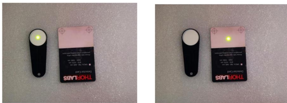
1064nm 照射下和 THORLABS 的 VRC4 显示效果对比图
