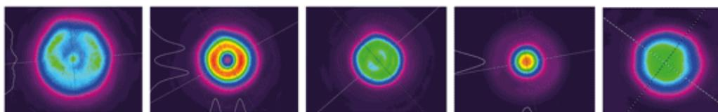
上图汇总了沿传播方向 (z 轴) 的归一化光束轮廓剖面。在焦平面/束腰位置  $\pm 1.5\text{mm}$  的范围内形成了 5 个不同的光束整形效果。不同工作平面对应的的光束整形效果以 2D 和横截面图的形式显示。
