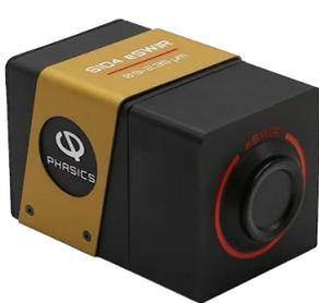
光谱范围: 0.9~2.35μm<br>光圈尺寸(mm <sup>2</sup> ): 9.60×7.68<br>空间分辨率: 120μm<br>相位采样(像素): 80×64<br>相位精度(绝对): < 40nm RMS<br>相位分辨率: < 6nm RMS<br>实时处理频率 > 10Hz (全分辨率) |
