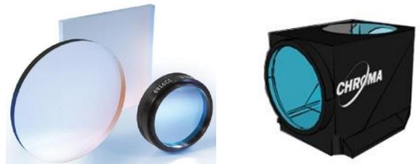
美国 Alluxa 超窄带滤光片，半峰宽可窄至 0.1nm，同时保持>80%的透射率，中心波长覆盖 226~1650nm。平顶窄带滤光片非常适合激光雷达，拉曼光谱和其他需要使用精密激光透射滤光片或激光清除滤光片的应用。Alluxa 还提供高性能的 10.6μm 红外陷波滤光片。
