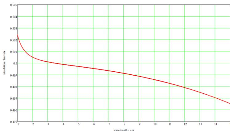
超宽带消色差 1/4 波片在 1000-15000nm 延迟精度
