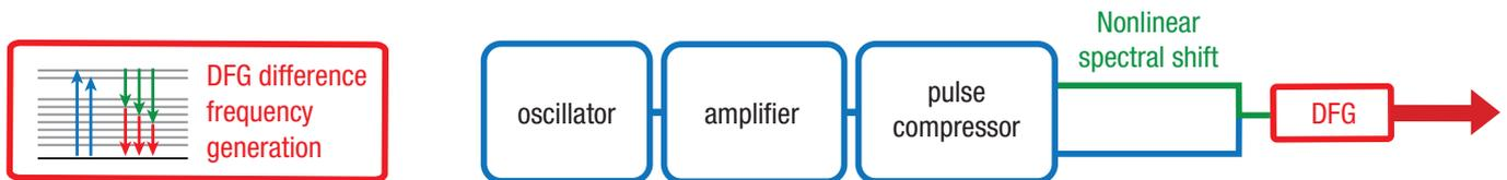
从Menlo交钥匙的、可靠的figure 9®光纤激光振荡器开始, 利用高非线性光纤中的移频, 实现了一个双色飞秒激光系统。不同波长的两路飞秒脉冲在空间和时间上重叠, 聚焦到一个非线性晶体中, 进行差频生成(DFG)。实现了在中红外范围内生成飞秒脉冲, 覆盖3  $\mu\text{m}$ 至5  $\mu\text{m}$  的光谱范围并具有高输出功率水平。波长可以在指定的波长范围内完全自动调整。
